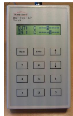
Testiyksikkö osoittaa aktiivisen lähdön C4 ja tulon C5.
